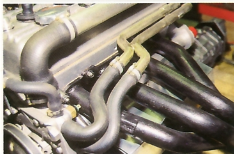
La nouvelle disposition de pompe à eau a nécessité la modification du système de tension de courroie d'alternateur. Les tuyaux d'aspiration et de refoulement de la pompe longent le moteur pour rejoindre le circuit d'origine.
