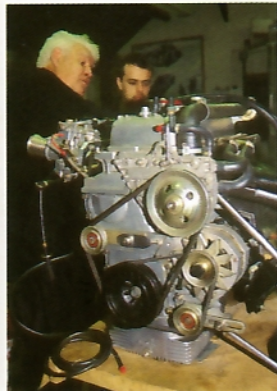
La nouvelle disposition de pompe à eau a nécessité la modification du système de tension de courroie d'alternateur. Les tuyaux d'aspiration et de refoulement de la pompe longent le moteur pour rejoindre le circuit d'origine.
