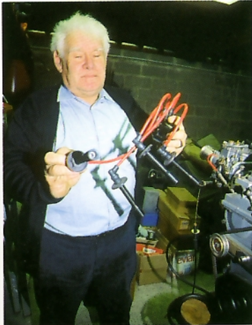
Le système de rallonge d'origine peu pratique et source d'ennui est maintenu par des cylindres de Téflon qu'il suffit de clipper sur les bougies.
