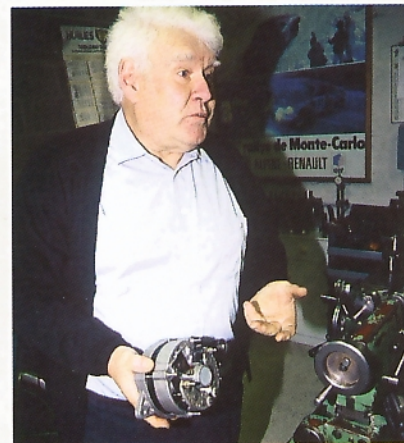
Les alternateurs retrouvent une seconde jeunesse grâce au frettage de bague de bronze au béryllium sur les pistes du rotor.
