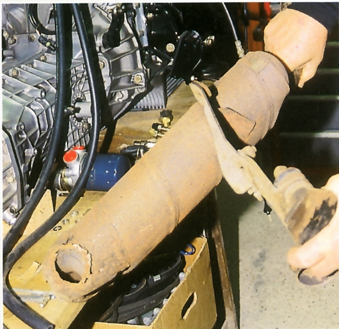
Alain Lagnitre nous présente le pot d'origine et ses fixations. Le tube d'entrée de silencieux maintes fois ressoudé et renforcé durant sa longue carrière avait fini par être soudé au collecteur par son ancien propriétaire.
