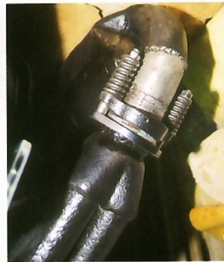
La fixation avant du pot a retrouvé de la souplesse grâce à un système à ressort aujourd'hui classique.
