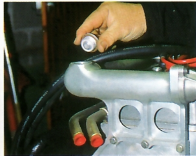
Cette pièce taillée dans la masse bouche le trou d'une éventuelle pompe à eau au niveau de la culasse d'origine 18 Turbo, ramène le circuit de refroidissement vers l'arrière et fait office de bouchon de remplissage.
